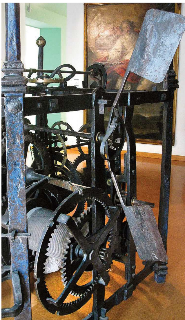
Fig. 5. Movimiento del reloj de la Seo de Gerona, siglo XVI. Detalles de la contadera y el venterol. Museo Municipal de Gerona.
