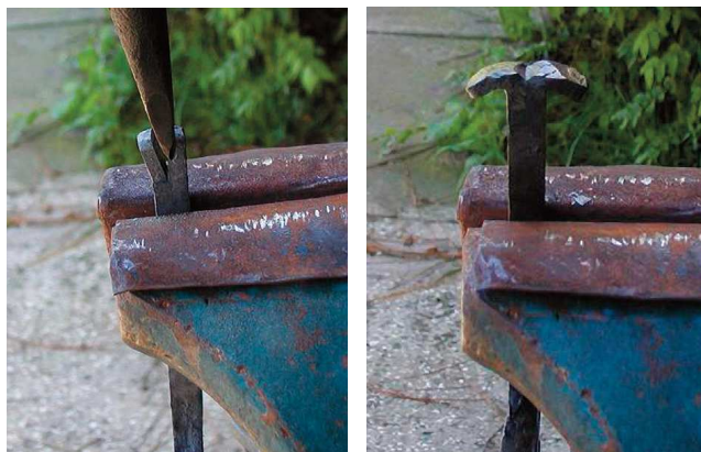
Figs. 36 y 37. Construcción de una rueda para un reloj de torre. Fabricación de la cruz. Fotografía de Scott F. Brown, herrero.
