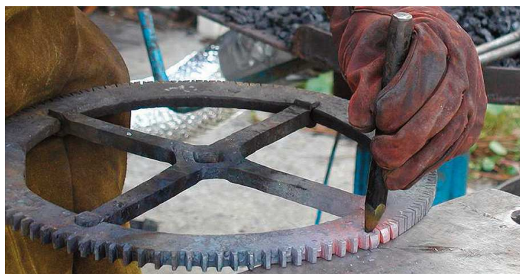
Figs. 41 y 42. Construcción de una rueda para un reloj de torre. Tras unir la cruz y el cerco, apertura de dientes en caliente mediante cincel. Fotografía de Scott F. Brown, herrero.
