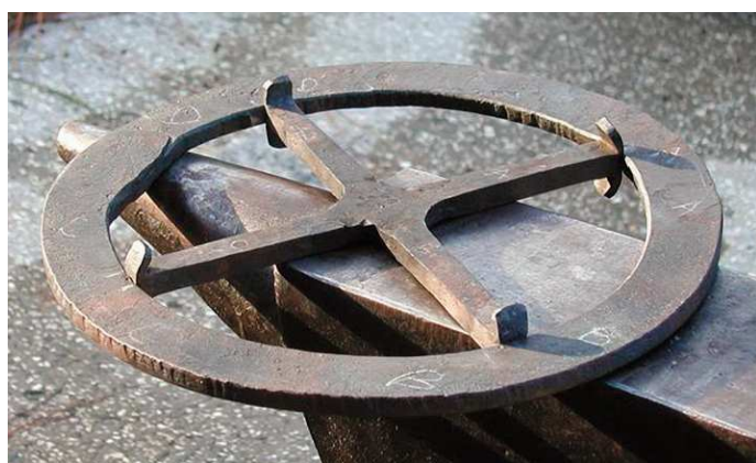
Figs. 38 y 39. Construcción de una rueda para un reloj de torre. Unión de la cruz al cerco. Fotografía de Scott F. Brown, herrero.
