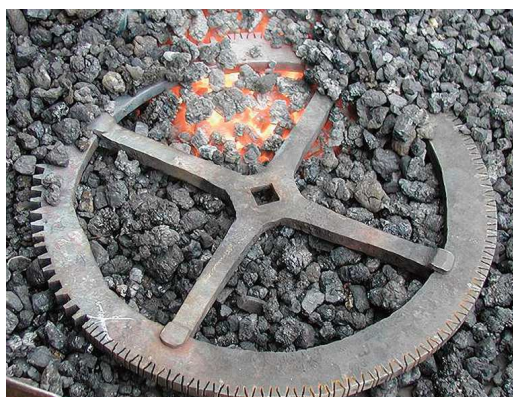
Figs. 41 y 42. Construcción de una rueda para un reloj de torre. Tras unir la cruz y el cerco, apertura de dientes en caliente mediante cincel. Fotografía de Scott F. Brown, herrero.
