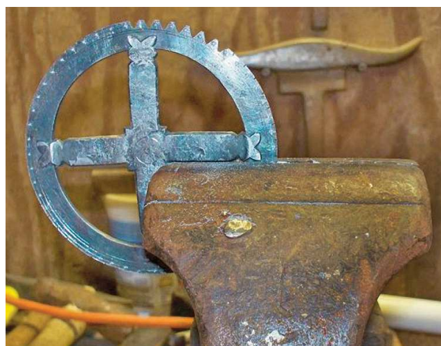
Fig. 43. Construcción de una rueda para un reloj de torre. Apertura de dientes a lima. Fotografía de Scott F. Brown, herrero.
