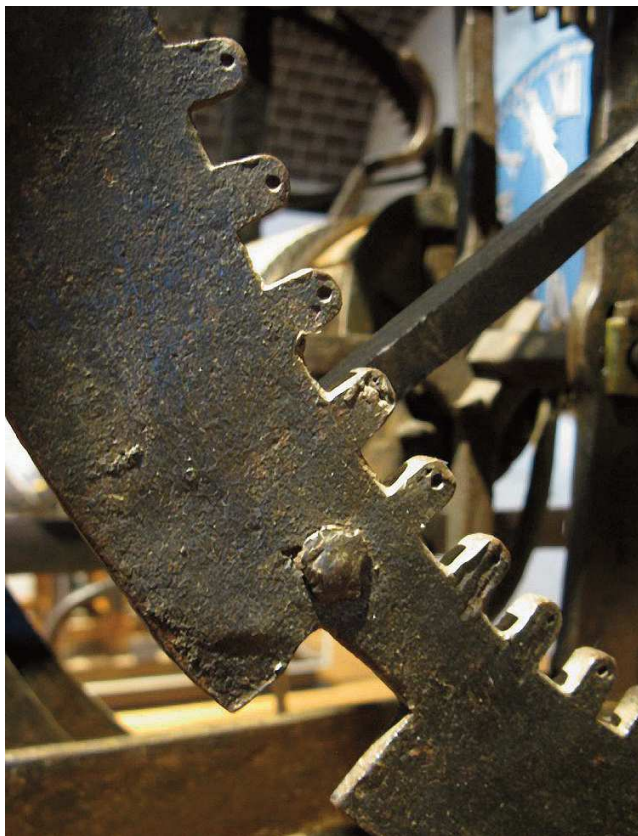
Fig. 40. Reloj de torre, siglo XVI. Detalle de los dientes de una rueda y de los puntos que se utilizaron para dividir la rueda en el número de dientes requerido. Musée International d'horlogerie, La Chaux-de-Fonds (Suiza).
