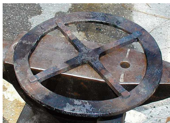
Figs. 38 y 39. Construcción de una rueda para un reloj de torre. Unión de la cruz al cerco. Fotografía de Scott F. Brown, herrero.
